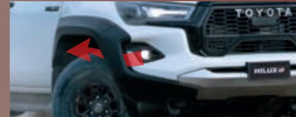
Paragolpes GR con canalizador aerodinámico
